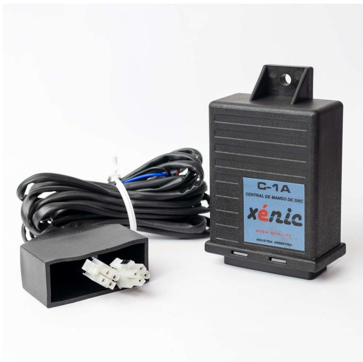
La central de mando de GNC es un modulo electrónico que se interpone entre algunos accionadores y sensores del motor y la unidad electrónica central del vehículo para su buen funcionamiento a gas. Cuenta con la capacidad de cortar y emular el inyector de nafta, producir el avance en el sistema de ignición necesario para el gas y cortar la señal del sensor sonda lambda para crear otra, para la nueva combustión generada por el gas.
