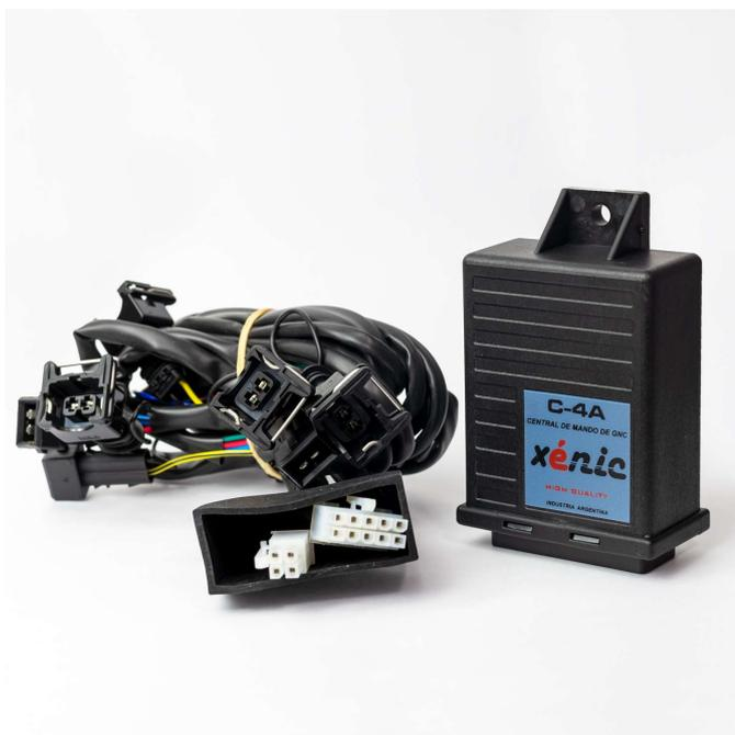
La central de mando de GNC es un modulo electrónico que se interpone entre algunos accionadores y sensores del motor y la unidad electrónica central del vehículo para su buen funcionamiento a gas. Cuenta con la capacidad de cortar y emular los cuatro inyectores de nafta, producir el avance en el sistema de ignición necesario para el gas y cortar la señal del sensor sonda lambda para crear otra, para la nueva combustión generada por el gas.
